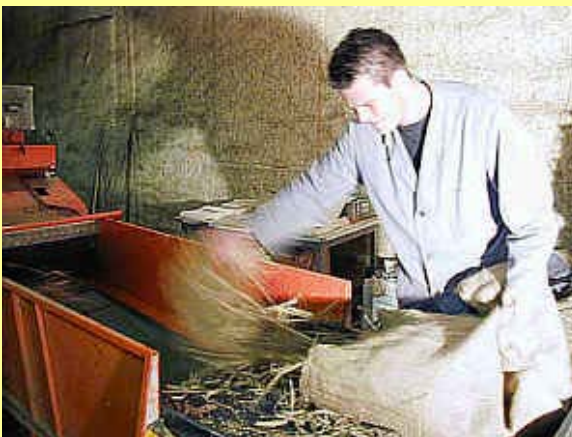
Ausdreschen der Probe auf der Standdreschmaschine
