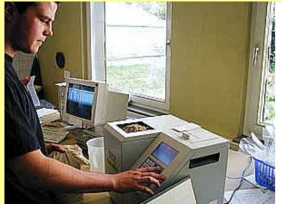
Die Waage und der Feuchtigkeitsmesser in der LUFA sind an den PC angeschlossen. Wichtige Daten der Proben zur Ertragsermittlung (Gewicht, Feuchtigkeit) werden per E-Mail an das Stat. Landesamt übermittelt.
