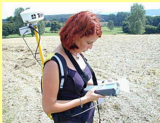
Das Feld wird umlaufen und die Probemessungen ergeben einen Flächenwert, der in einen PC übertragen wird.
