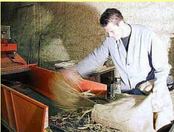
*Ausdreschen der Probe auf der Standdreschmaschine*
